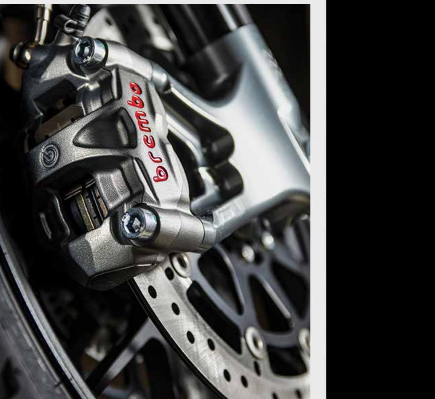
L'impianto frenante può contare all'anteriore su pinze radiali monoblocco a quattro pistoncini, doppio disco flottante da 320 mm ed una pompa semi-radiale, tutto firmato Brembo; al posteriore, pinza a due pistoncini con disco da 220 mm dal disegno specifico.
