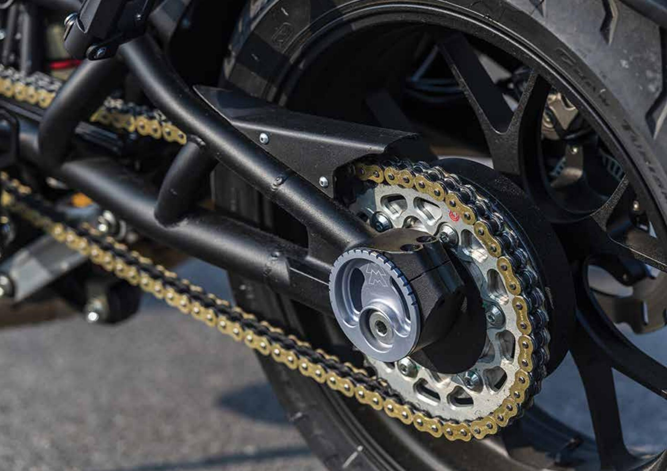
La ciclistica della nuova Moto Morini Milano si basa sul già noto traliccio in acciaio ma modificato per offrire un elevato livello di guidabilità, anche per i motociclisti meno esperti. A traliccio anche il nuovo forcellone che lascia ampia visibilità sulla ruota posteriore in alluminio forgiato.
